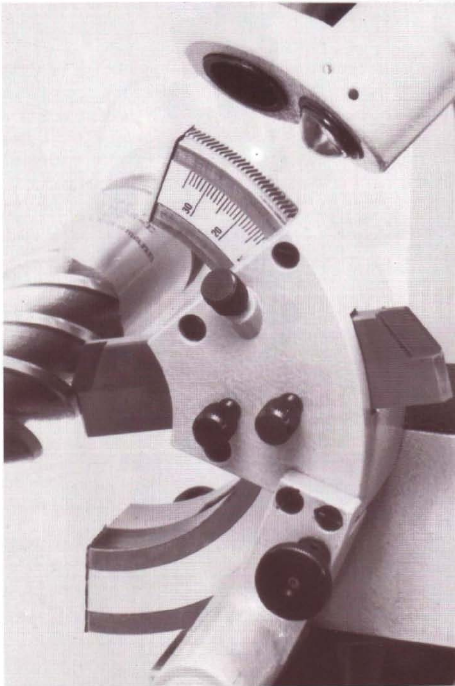
Antasten der Freifläche zur Messung des Freiwinkels
