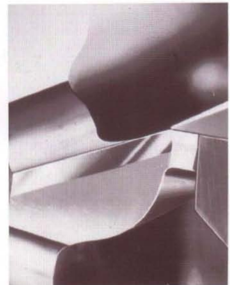
Antasten der Freifläche zur Messung des Freiwinkels
